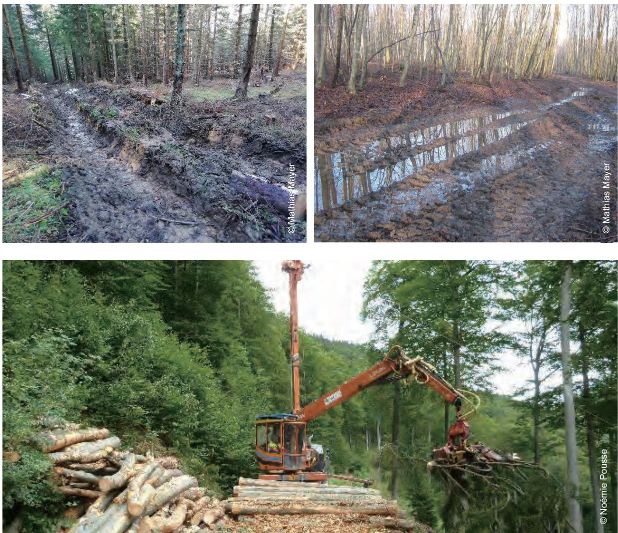
照片 1. 奧地利（左上）和法國（右上）的慣行集材機採伐對土壤的擾動（車轍形成和土壤壓實）。奧地利阿爾卑斯山的架線集材作業（下）
