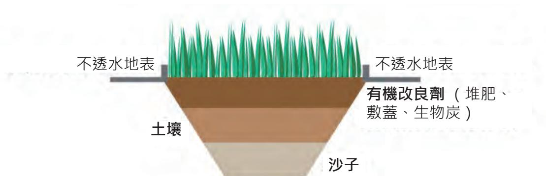
圖 14. 生物滯留系統示意圖
